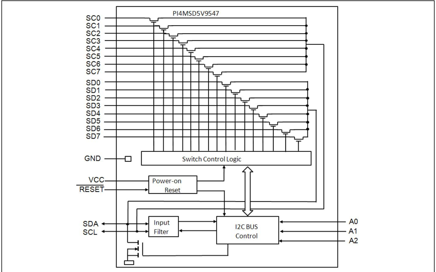
**Figure 1. Block Diagram**
