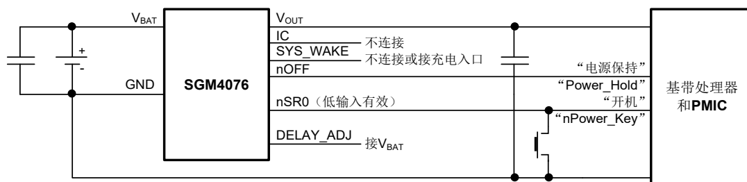
图 1. 采用惯用“开机”和“电源保持”2个控制信号的应用电路
