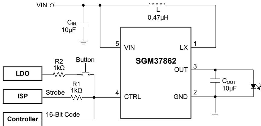
图 7. 控制器相应引脚复位状态为低电平时的按钮手电控制电路
