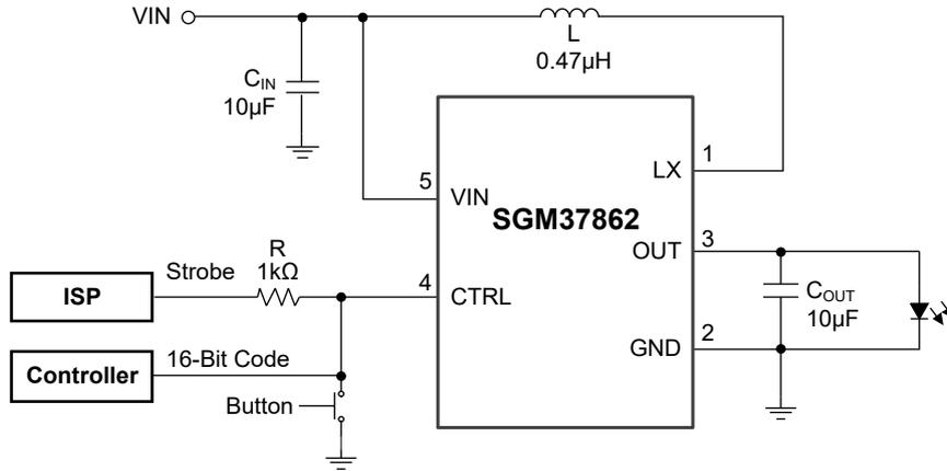
图 6. 控制器相应引脚复位状态为高电平时的按钮手电控制电路
