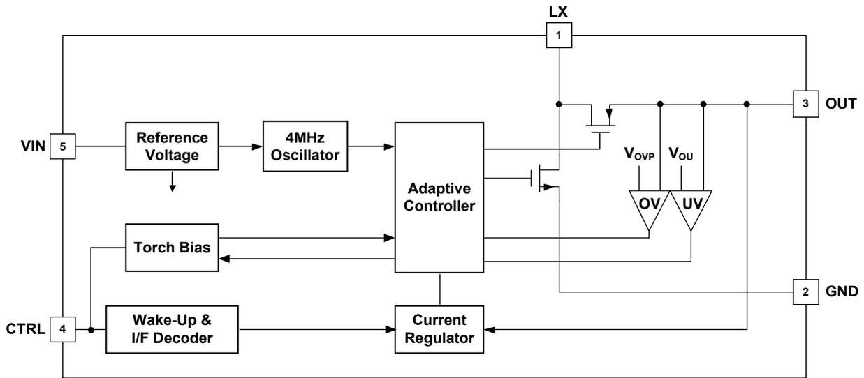
图2. 内部结构示意图
