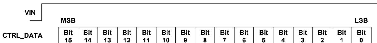
图3. 16b位码流示意图
